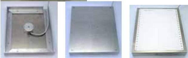
センサを筐体に固定。蓋を載せる。点字用紙を載せる。
